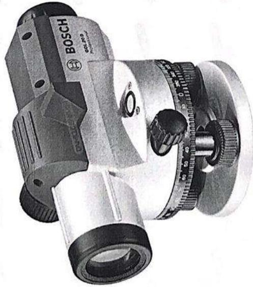
**Нивелир** - екі нүкте биіктіктерінің айырмашылығын анықтауға арналған құрылыстық геодезиялық аспап; көлденең нысаналау сәулесі мен осы нүктелерде тік орнатылған рейка көмегімен қолданылады.
